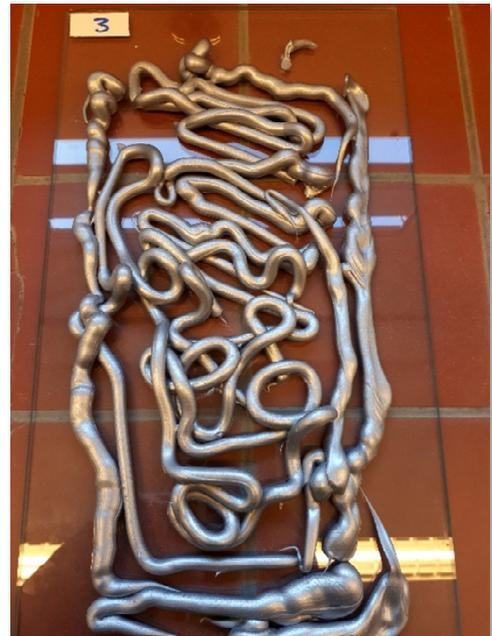
Zur Eluatherstellung wurde die Dichtmasse mittels Handdruckpresse auf eine inerte Glasoberfläche appliziert und unter konstanten Laborbedingung ( $20 \pm 2$  °C) über einen Zeitraum von 7 Tagen
